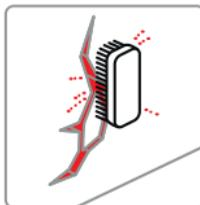
Avant durcissement total, brosser et façonner le mastic à l'aide d'une brosse métallique ou à poils durs.
