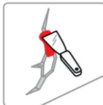
Rapprocher les deux morceaux et les mettre en contact par une légère pression.
